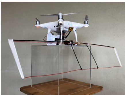
受信機とアンテナを搭載したドローン
